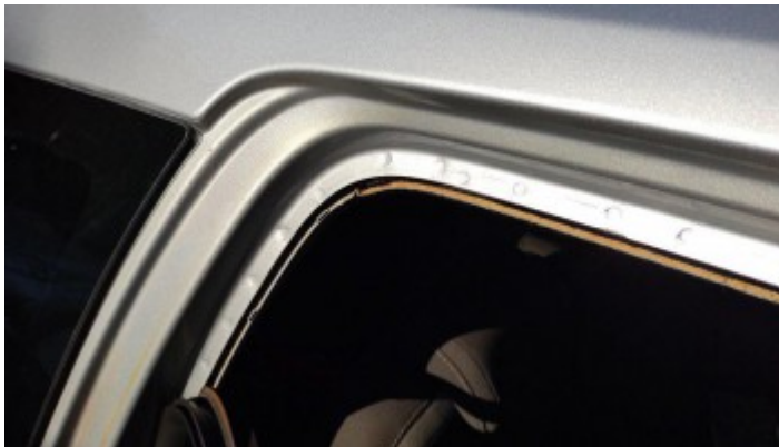
Estrutura Coluna Traseira Direita
