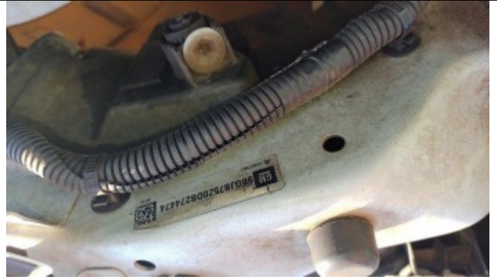
Etiqueta ETA (compartimento do motor)
