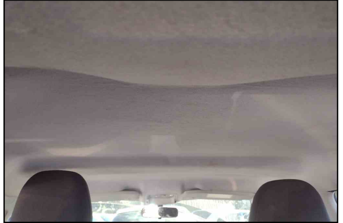
REVESTIMENTO DO TETO
