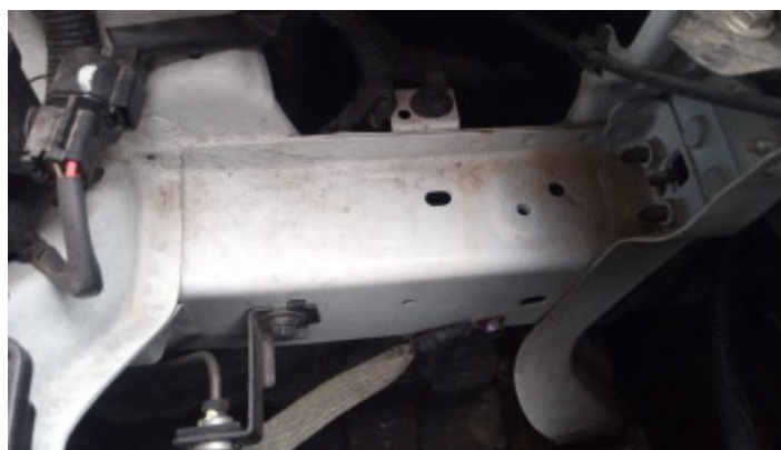
Estrutura Longarina Esquerda
